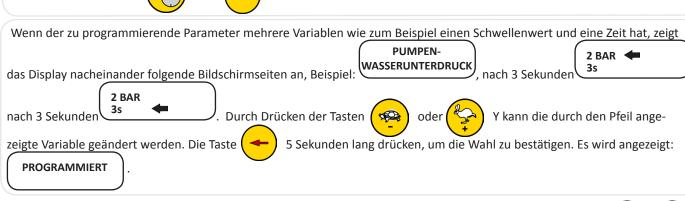
Zum Verlassen der Programmierung gleichzeitig die Tasten X Y drücken oder 30 Sekunden lang keine Taste drücken
